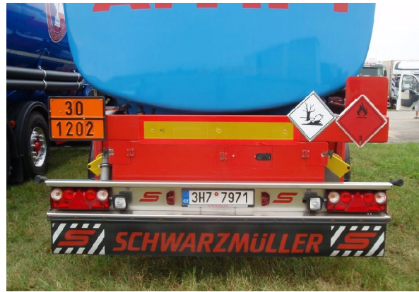
Obr. 3 Cisternový náves s označeniami a reflexnou ceduľou (foto Rosecký J., 2015)
