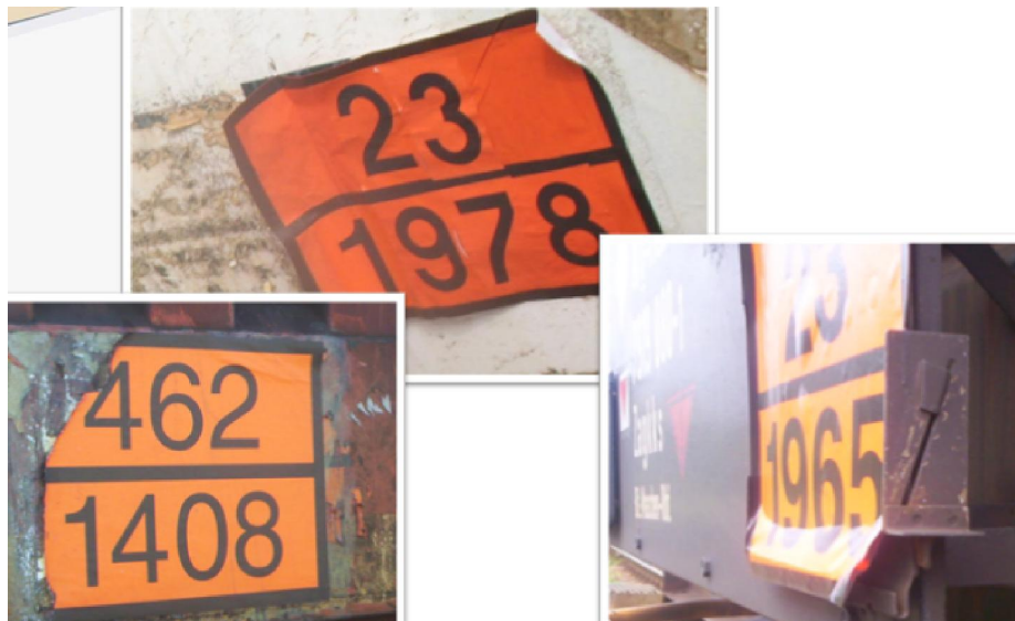
Obr. 16 Poškodené oranžové označenie (zdroj: ZSSK CARGO a.s.)
