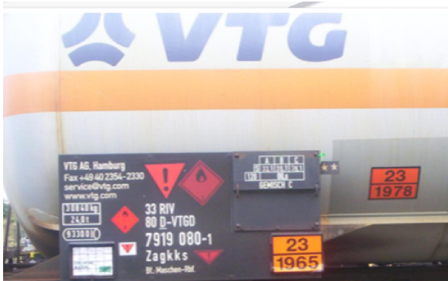
Obr. 15 Nesprávne oranžové označenie (zdroj: ZSSK CARGO a.s.)
