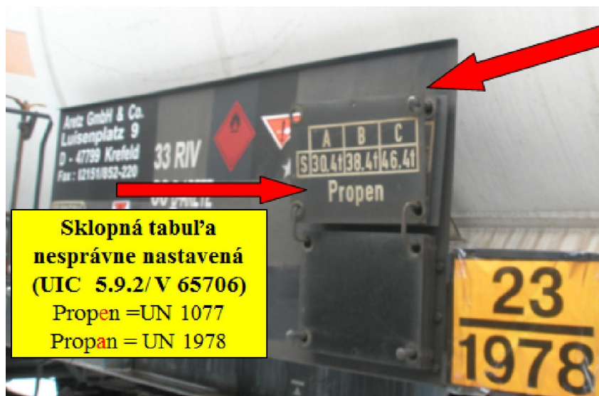
Obr. 13 Nezaistená sklopná tabuľa (zdroj: ZSSK CARGO a.s.)
