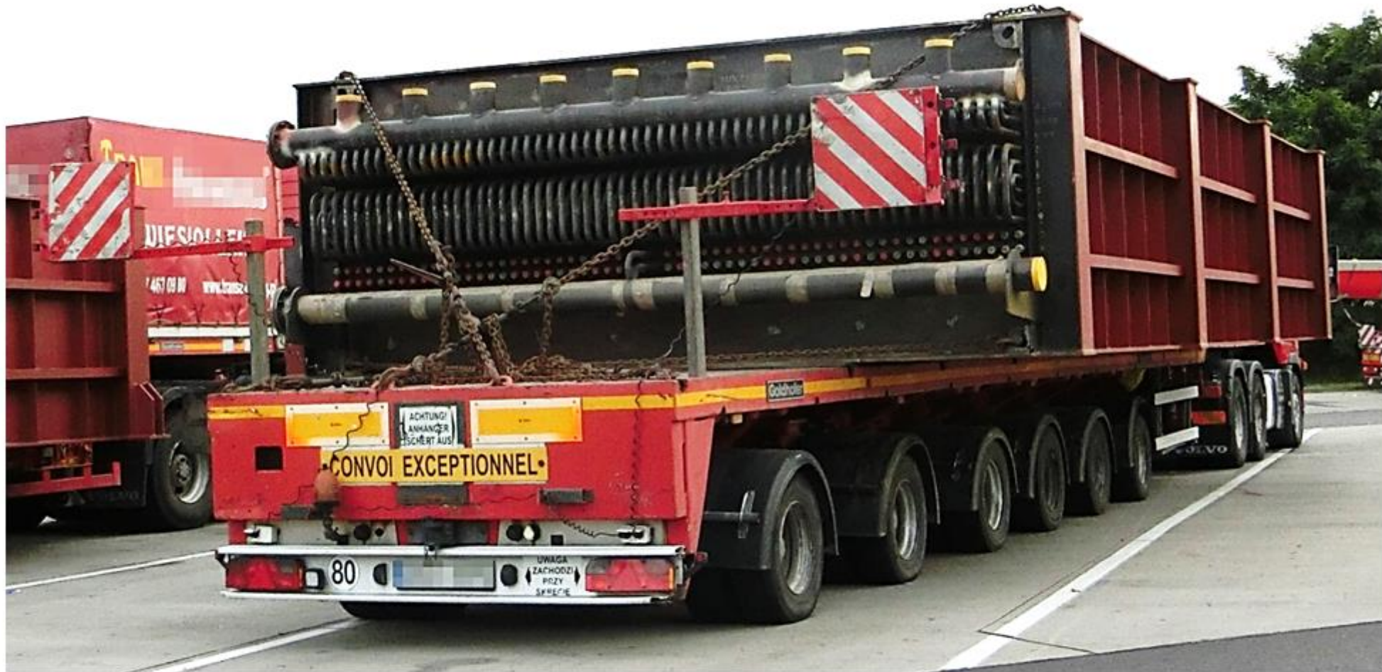
Obrázok 7 - Nadmerná a nadrozmerná preprava vrátane označenia prečnievajúceho nákladu a zvláštnej prepravy (CONVOI EXCEPTIONNEL)
